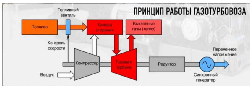
Рисунок 2 – Принцип работы газотурбовоза Г1-01
