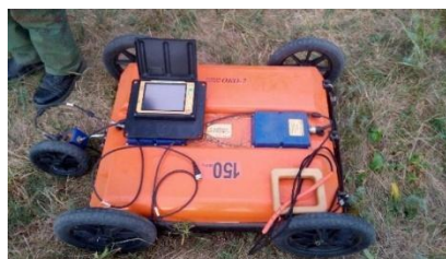
Рисунок 4 – Инженерно-геофизические работы георадиолокационные исследования с применением георадара «ОКО-3» (на тележке) и «ОКО-2» (правое фото)
