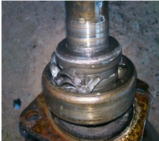
Рисунок 1 – Следы механического повреждения подшипника
