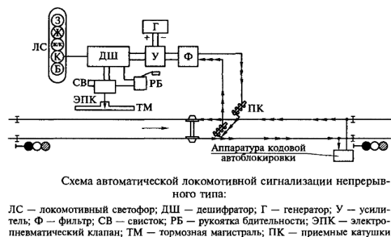
Рисунок 1 – Устройства АЛСН на станции
