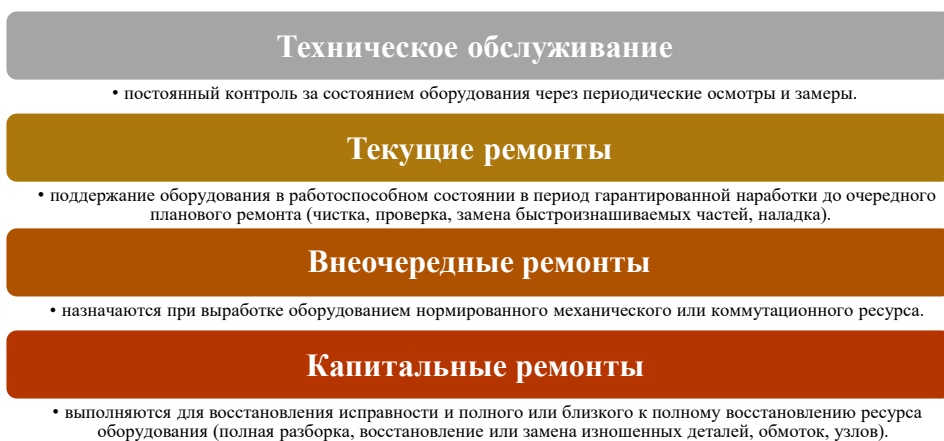
Рисунок 1 – Виды обслуживания подстанций
