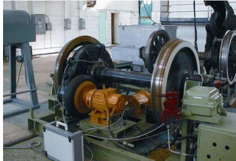
Рисунок 1 – Вибродиагностика в депо
