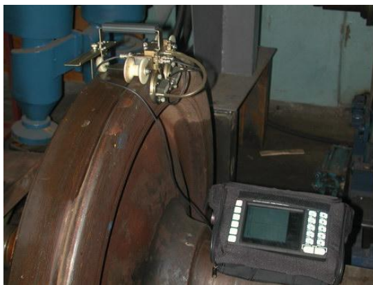
Рисунок 2 – Ультразвуковой метод контроля с помощью устройства УД2-70
