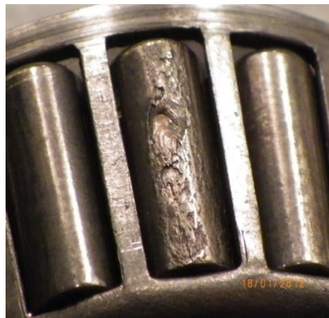
Рисунок 2 – Следы «интенсивного проворота» заклинившего подшипника под адаптером
