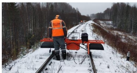
Рисунок 4 – Инженерно-геофизические работы георадиолокационные исследования с применением георадара «ОКО-3» (на тележке) и «ОКО-2» (правое фото)
